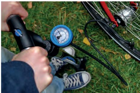
**Eine Fußpumpe mit Manometer ist praktisch**
