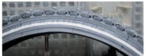
**Der richtige Luftdruck steht auf der Reifenflanke**
