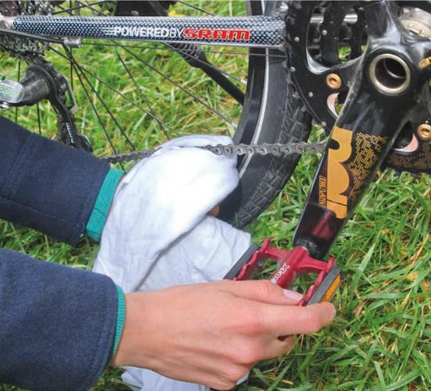
Überflüssiges Öl und Schmutz von der Kette entfernen (Foto: [www.pd-f.de](http://www.pd-f.de) / H. Heinemann)
