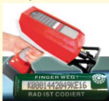
Mit der Markierpistole wird der EIN Code mit kleinen Nadelschlägen in den Rahmen gehämmert. Dabei wird, anders als bei der Gravur, kein Material entfernt, sondern lediglich verformt.
