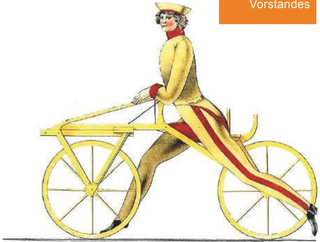
Abb.: Wikipedia – Drais' Maß-Laufmaschine von 1817
