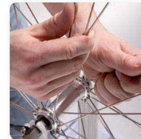
Prüfen Sie, ob eine Speiche gerissen oder locker ist, indem Sie benachbarte Speichen mit Daumen und Zeigefinger zusammendrücken. Eine ungleichmäßige Speichenspannung und gerissene Speichen ziehen auf Dauer weitere Defekte nach sich.
